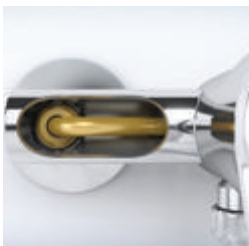
Tecnologia Securitouch: tubo isolado do corpo da torneira
