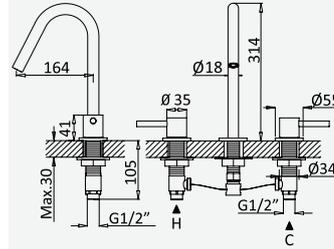
**Misturadora de lavatório 3 furos, montagem à bancada**
