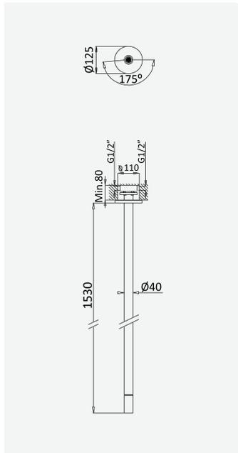
**Misturadora progressiva de lavatório, montagem ao tecto - 1,5 mt - Elo**
