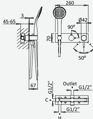
Sistema embutido de duche com chuveiro de parede Ø230 mm em ABS e kit de chuveiro mão Emotion
