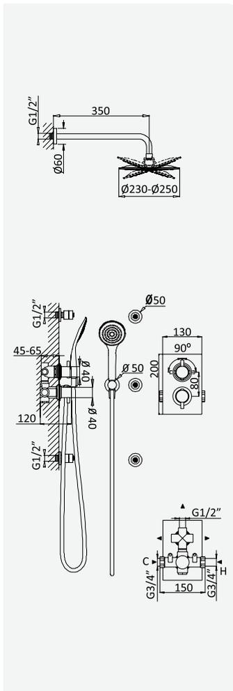
Sistema termostático embutido de duche com chuveiro de parede Ø230 mm em ABS, 3 jets e kit de chuveiro mão Emotion
