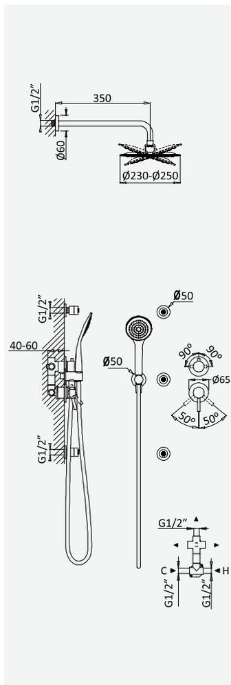
**Sistema embutido de duche com chuveiro de parede Ø230 mm em ABS, 3 jets e kit de chuveiro mão Emotion**
