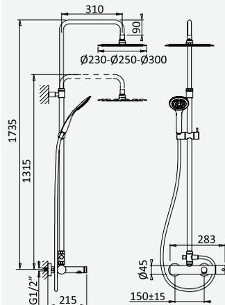
**Sistema de banheira com braço ajustável, chuveiro de Ø230mm em ABS e rampa de duche**
