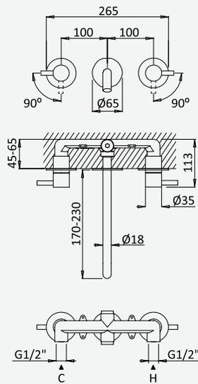
**Misturadora de lavatório à parede, 3 furos. Bica com 230mm**
