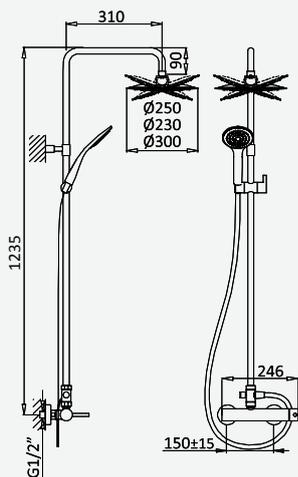
**Sistema de duche com braço fixo, chuveiro de Ø230mm em ABS e rampa de duche**
